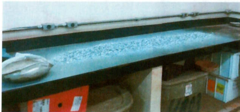
Figura 10. Pilha Alongada construída para amostragem (Fonte: Arquivo Pessoal).
