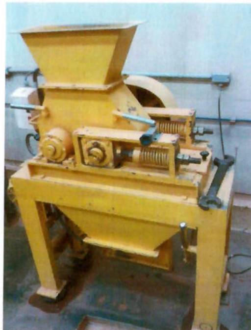
Figura 11. Britador de Rolos utilizado na cominuição do material (Fonte: Arquivo Pessoal).
